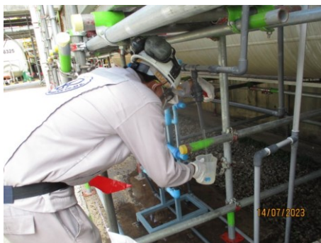
ภาพที่ 3.2.8-1 การเก็บตัวอย่างน้ำระบายทิ้ง จากระบบผลิตน้ำหล่อเย็น (Cooling Tower)
